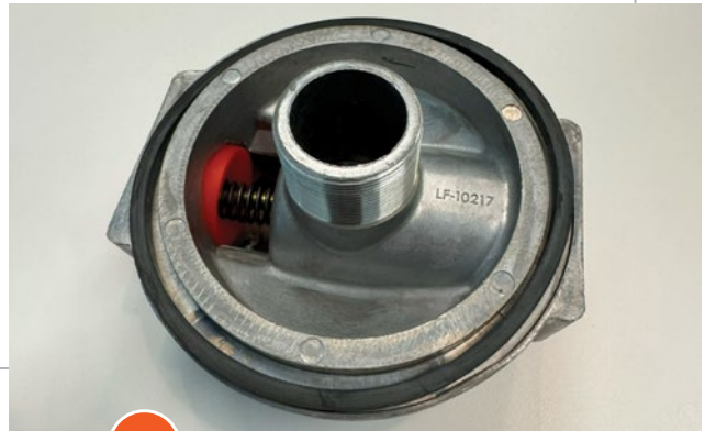
ARO DE GOMA INSTALADO INCORRECTAMENTE
