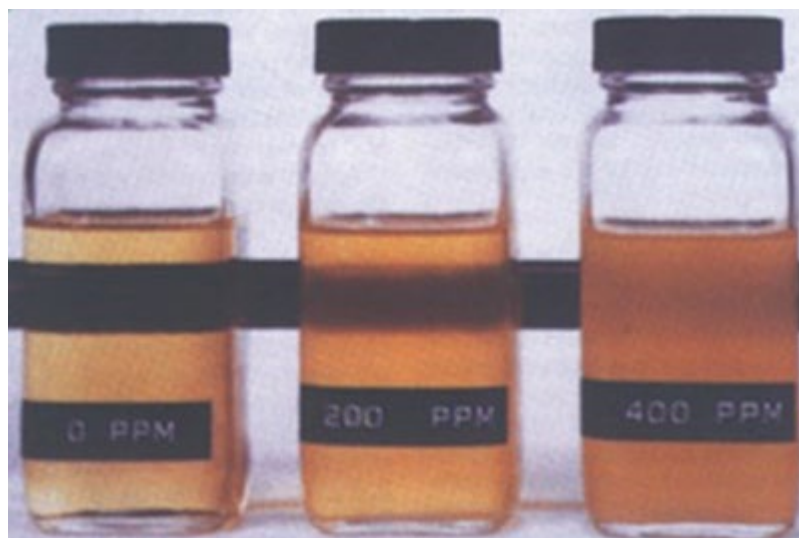
Figura 1. Aquí se muestra el fluido hidráulico seco a la izquierda y cantidades crecientes de agua emulsionada (agua en aceite) al centro y a la derecha.
