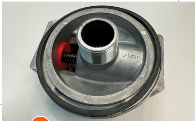
✗ ARO DE BORRACHA INSTALADO INCORRETAMENTE
