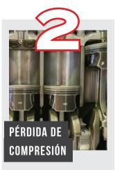
Las partículas en la cámara de combustión van a causar desgaste prematuro en los cilindros, generando pérdida de compresión prematura que es sinónimo de pérdida de potencia y mayor consumo de combustible a lo largo de la vida útil del motor de hasta 7%.
