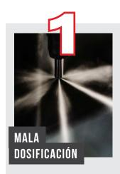
Los sistemas de inyección requieren un diésel ISO 11/8/7 para dosificar de manera óptima el combustible. La mala dosificación del inyector por presencia de partículas es sinónimo de pérdida de potencia y por ende mayor consumo de combustible de hasta 5%.
