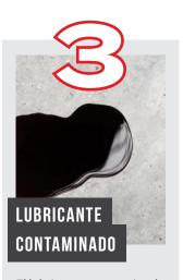
El lubricante contaminado de partículas eleva las fricciones y la temperatura, siendo causante de hasta un 2-3% de pérdida de potencia y mayor consumo de combustible.
